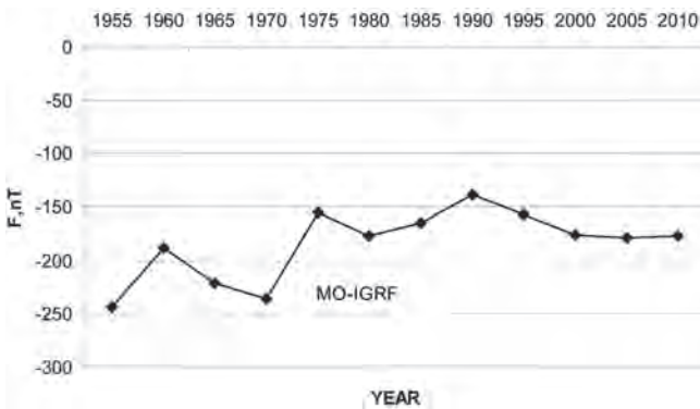
Рис. 6. Разность значений полного вектора МПЗ, измеренных с использованием оборудования МО «Владивосток» и вычисленных по модели IGRF
