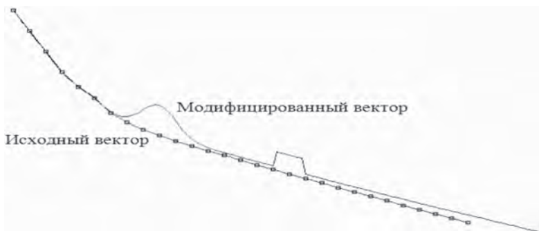
Рис. 10. Пример модификации вектора логарифма электронного давления
