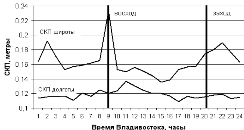
Рис. 2. Суточные изменения случайных погрешностей широты и долготы для окна сглаживания 1 мин
