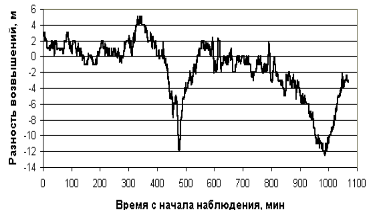
Рис. 11. График разностей возвышений антенны приёмника SPR-1400 над геоидом
